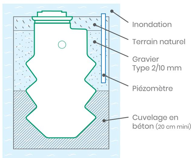
• **Cuvelage** : ensemble étanche et continu protégeant une construction enterrée contre les eaux.
